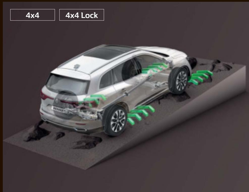
Sélectionnez Auto pour passer automatiquement en mode 4x4 lorsque la situation l'exige, et bénéficiez d'une répartition automatique du couple entre les roues avant et arrière. Choisissez le mode Lock pour une transmission permanente des quatre roues et une répartition fixe du couple entre l'avant et l'arrière, afin de maximiser la capacité de franchissement et la stabilité dans tout environnement. Passez à l'action et dépassez-vous avec le All Mode 4x4-i de Renault KOLEOS !
