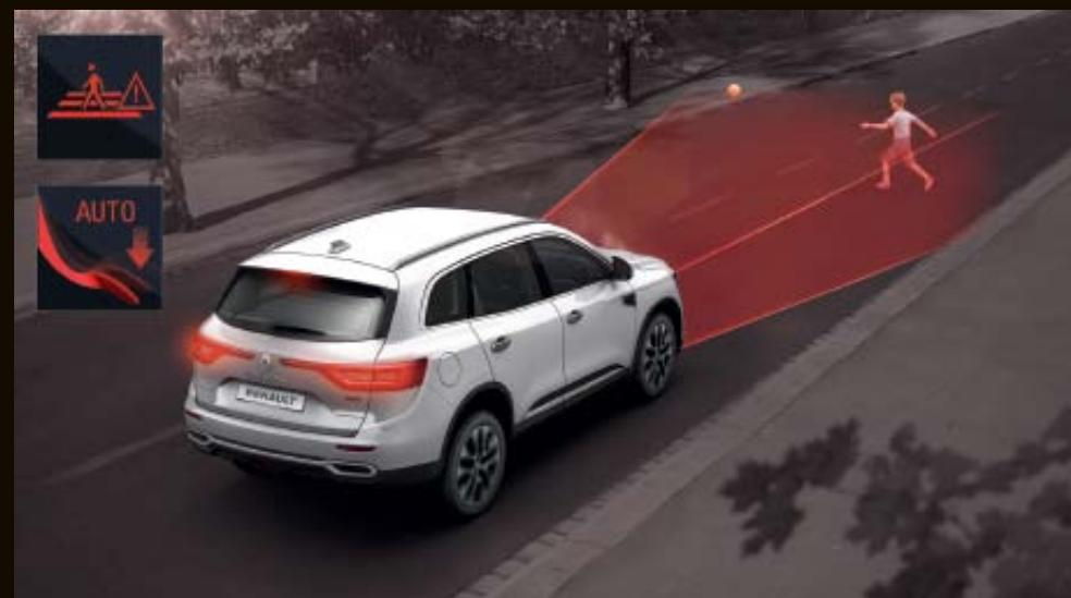
**Freinage actif d'urgence avec détection piétons.** Le système prend le relais en cas de risque de collision avec le véhicule qui vous précède ou avec un piéton qui surgit. Une alerte survient, si vous ne réagissez pas ou insuffisamment, les freins sont automatiquement activés.
