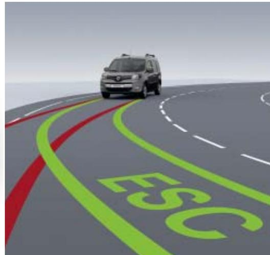
Contrôle dynamique de trajectoire (ESC – Electronic Stability Control). Cette nouvelle génération combine le système antipatinage (ASR) et le contrôle de sous-virage (CSV) avec l'Extended Grip et l'aide au démarrage en côte.
