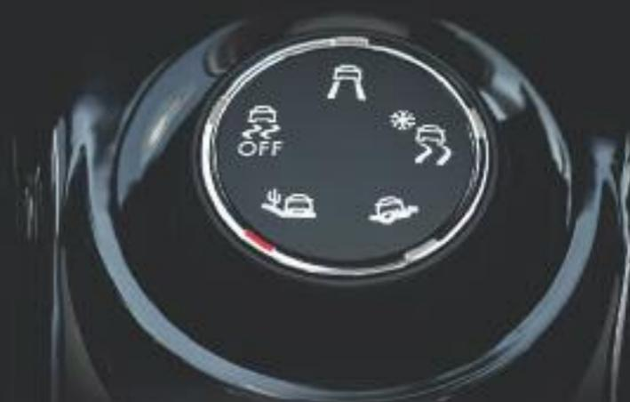
Polyvalent et souple, le Grip Control® optimise la motricité en fonction du terrain emprunté en agissant sur les roues avant, par un pilotage électronique par l'ESP. Disponible sur les moteurs à partir de 100ch, en boîtes de vitesses manuelle et automatique, il est associé à des pneumatiques 16" ou 17".
