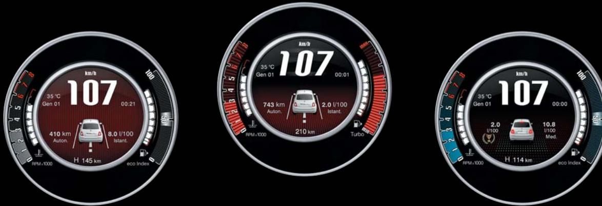
Pour cette raison, elle a choisi d'embarquer un **écran numérique TFT de 7"**. Il sert à contrôler toutes les informations qui peuvent être utiles pendant la conduite ; comme par exemple, les données du tachymètre, du compte-tours, de la température ou de l'indicateur de boîte de vitesses et de l'ordinateur de bord. De plus, le tout permet de consulter, sur le même écran, le lecteur multimédia, le téléphone et le navigateur.
