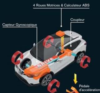
**ALL MODE 4X4-i\*:** Cette transmission utilise des capteurs électroniques qui contrôlent le patinage des roues pour répartir automatiquement le couple jusqu'à 50% sur les roues arrière. Couplé à l'ESP (Contrôle électronique de la trajectoire), le système peut contrôler chaque roue de manière indépendante.
