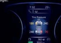
**PRESSION DES PNEUS.** La pression des pneus s'affiche sur l'écran d'information. En cas de détection d'une perte de pression, un signal vous alerte.
